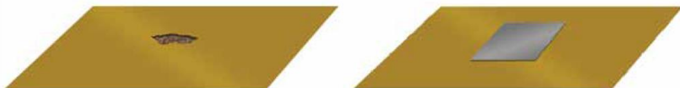
Figure 6 : Réparation de trous dans la TM520 VBP
