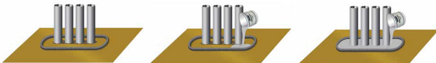
Figure 5 : Fermeture de plusieurs perforations à l'aide d'une colle époxy
