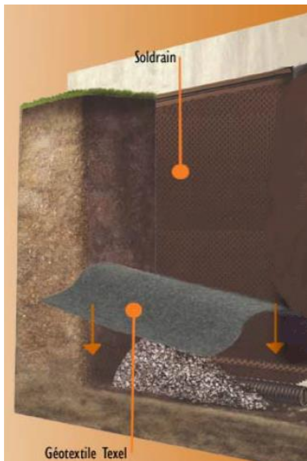
Figure 3: Exemples d'installations et de raccordements avec et sans dépassement du Soldrain
