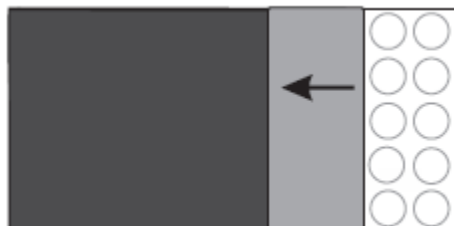
Figure 7: Décrochement du géotextile pour exposer deux rangées d'alvéoles
