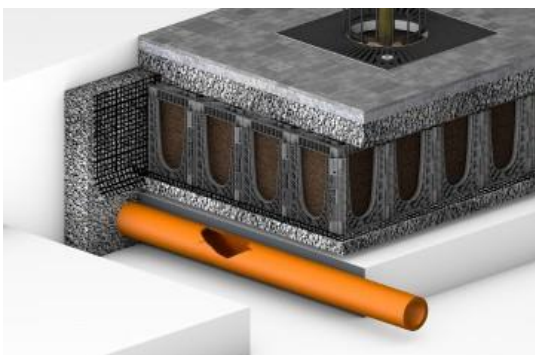
7. Excavez sous le RootSpace® pour accéder aux services publics et les réparer.
